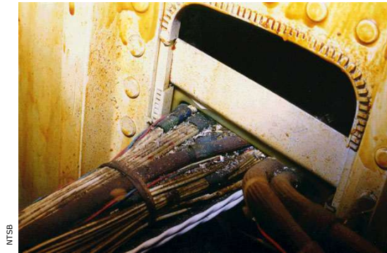
Copeaux de forage et contamination d'un toron sur un Boeing 747
