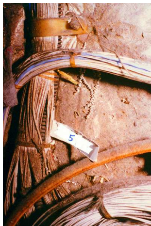
Copeaux de forage et contamination d'un toron sur un Airbus A300
