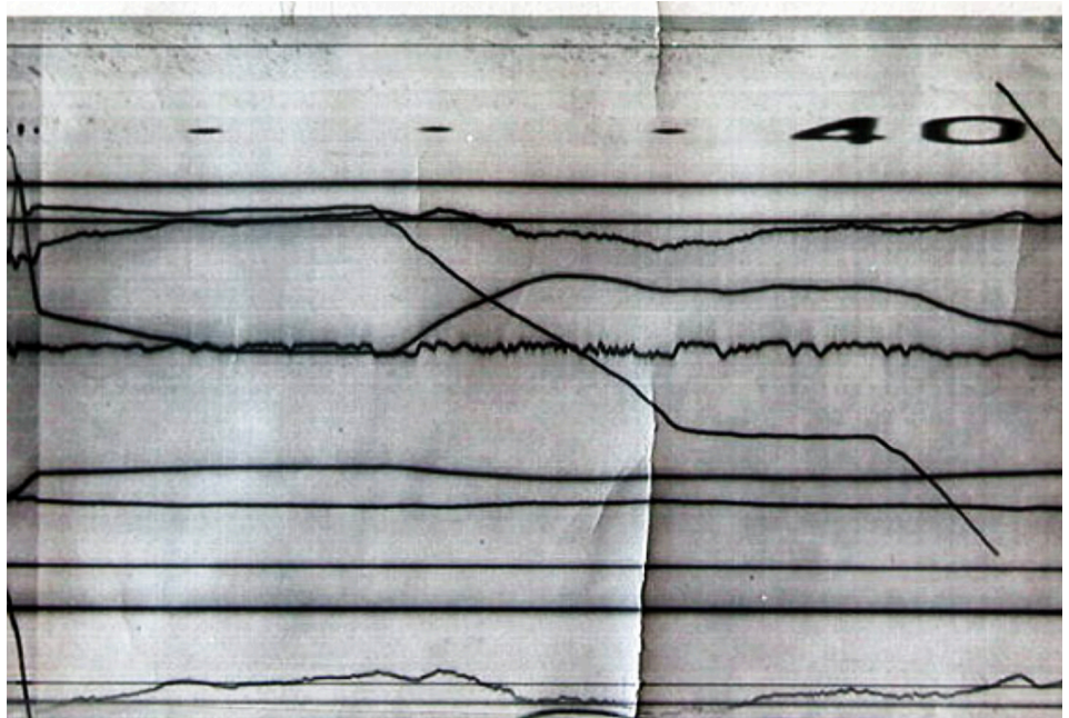
Enregistrement de paramètres de vol sur une feuille métallique (BEA).
