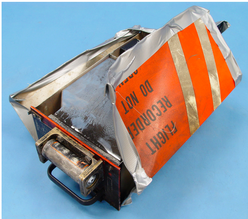
L'enregistreur de conversations du British Aerospace Jetstream 3201 N875JX de Corporate Airlines a été récupéré par les enquêteurs du NTSB en relativement bon état après l'accident du vol 5966 le 19 octobre 2004 qui a fait 13 morts et deux blessés sérieusement atteints (NTSB).
