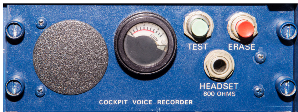
Le panneau de commande de l'enregistreur de conversations dans le cockpit d'un Dornier Do-328. À gauche du vumètre, le microphone de prise de son d'ambiance (CAM-Cockpit Area Microphone) (Pierre Gillard).
