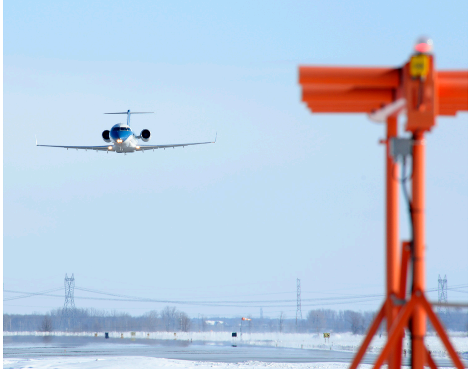
Le CRJ-200 survolant la piste 24 droite lors de sa première approche. Au premier plan, un élément du réseau d'antennes du Localizer (Pierre Gillard).
