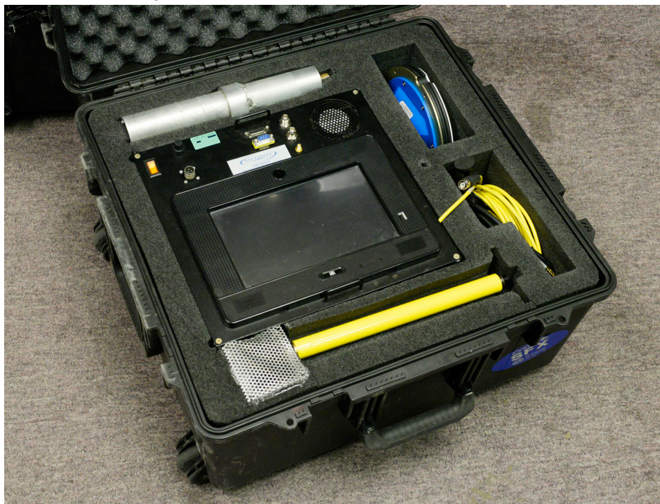
Le TPRU est un système de GPS différentiel qui est transporté dans une valise et installé sur chaque site à inspecter (Pierre Gillard).
