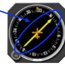
Aiguille indiquant la direction de l'origine de l'émission
