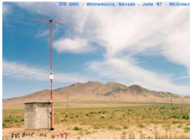
La polarisation de l'onde électromagnétique est verticale
