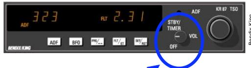
Interrupteur « marche-arrêt » et réglage de volume
