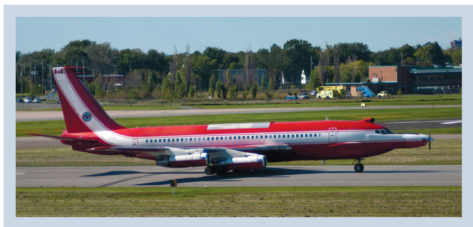
En septembre 2011, le Pratt 720 a réalisé l'un de ses derniers vols d'essai du moteur PT6, que l'on voit sur son nez.
