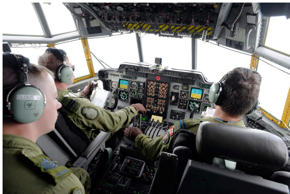
**L'instrumentation du cockpit de l'Hercules «344» comporte des écrans électroniques EFIS (Pierre Gillard).**
